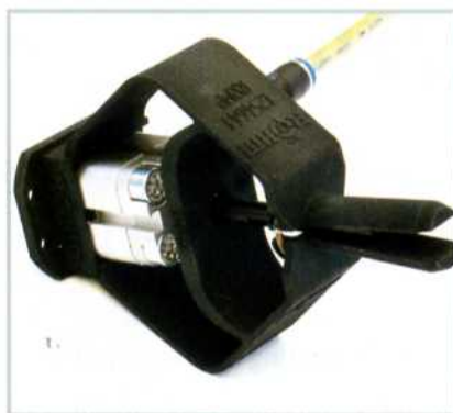
Ein Kolben, der den Spanndorn zusätzlich aufspreizt, sorgt für eine noch größere Kontaktfläche an der Werkstückinnenseite und sichert so die Innenanlage
