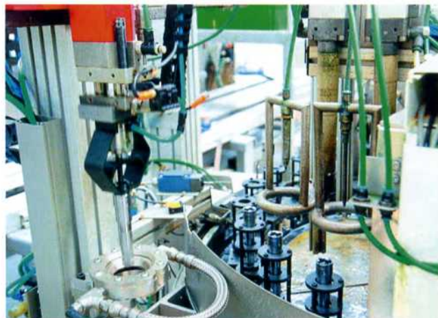
An die Anforderungen angepasst, kann die Kunststoffgreiferlösung die Werkstücke zuverlässig greifen. Sie lassen sich hängend durch die Ringöse mit dem Luftstrom führen
