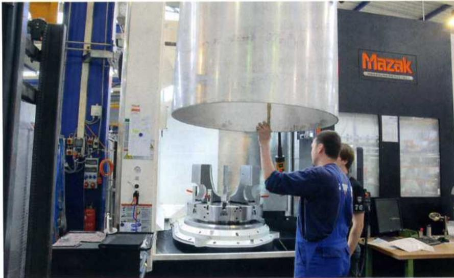
▲ Mit dem seit Anfang 2014 eingesetzten 8-Backen-Futter von Röhm mit Backen-Schnellwechselsystem reduziert Zimmerlin die Rüstzeiten deutlich
