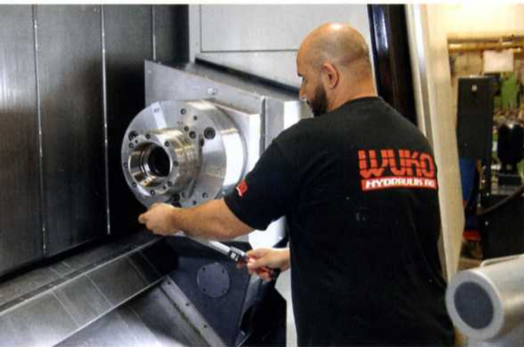
Abbildung 5: Eingerastet mit dem Bajonettverschluss und mit drei Schrauben verschraubt, ist das Futter sehr schnell einsatzbereit
