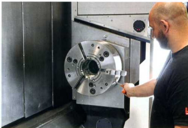
Bild 3: Das Kraftspannfutter DURO-NCSE Flex eignet sich besonders für Bearbeitungen mit häufigem Wechsel des Spannzeuges, da hier nur die Spanneinsätze mit einem Schnellwechselsystem getauscht werden
