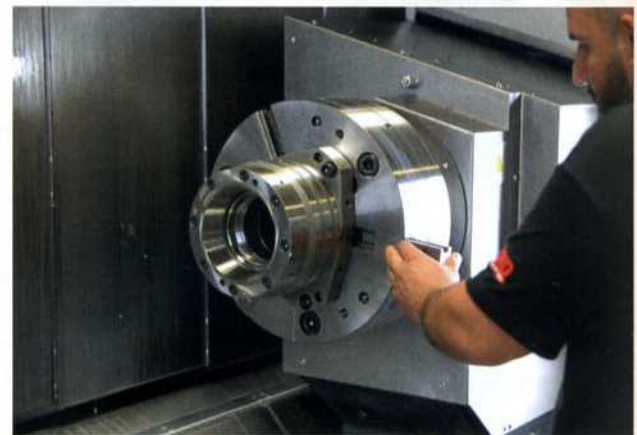
Bild 4: Für die Stangenbearbeitung bestens geeignet: Kraftbetätigtes, flexibles Spannzangenfutter KZZT-AF
