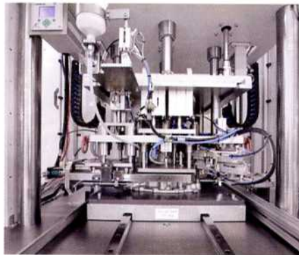
Die Bauteil berührenden Elemente werden von den Zeltwanger Konstrukteuren individuell an die Prüfteile angepasst
