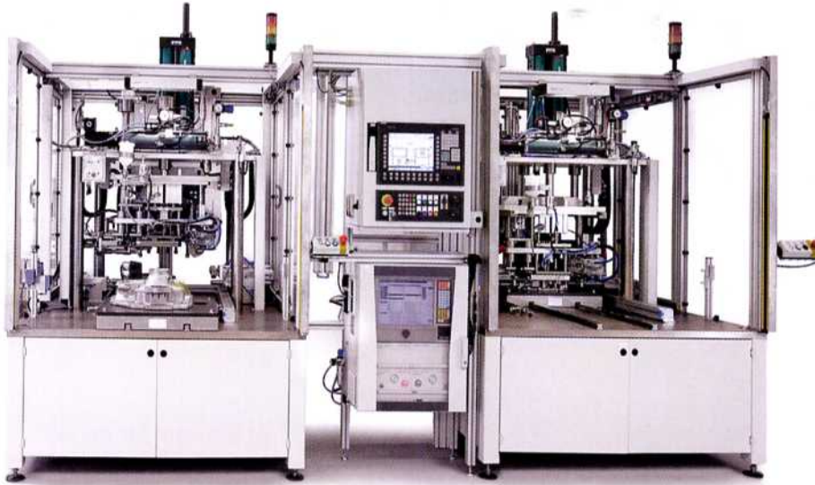
Mit kurzen Taktzeiten lässt sich die modular aufgebaute Dichtheitsprüfanlage mit Schiebeschlitzen zur Qualitätssicherung ideal in eine Hundertprozentkontrolle einbinden
