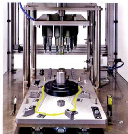
Der Schiebeschlitten der Zeltwanger Dichtheitsprüfanlage lässt sich sowohl manuell als auch automatisiert durch Roboter beladen
