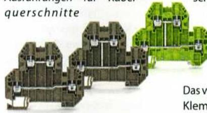
von 10 mm<sup>2</sup>. Die Durchgangsklemmen sind mit zwei mal zwei Anschlüssen oder mit vier Anschlüssen erhältlich. Das Schraubanschluss-Element ermöglicht ein sicheres und schnelles Anschließen von starren und flexiblen Adern mit und ohne Aderendhülse. Dabei vereinfacht
