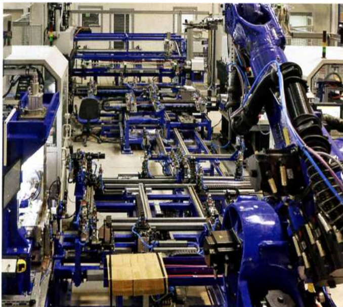
Vollautomatische Fertigungszelle zur Herstellung von Aluminium-Stromschienen.
