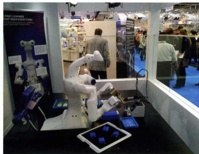
Der Doppelarmroboter ist dank vieler integrierter Sensoren – wie Kameras, Kraftsensoren oder Beschleunigungsmesser – für eine weitgehend autonome Produktion ausgelegt.
