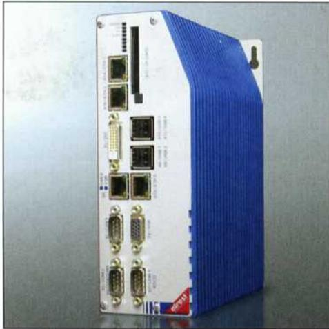
delle der 700er-Serie. Sie arbeiten mit Intel Core2-Prozessoren unter dem vorkonfigurierten Betriebssystem Microsoft Windows XP embedded und eignen sich damit für aufwendige Aufgaben wie beispielsweise das Messen, Steuern, Regeln und Prüfen von Prozess- und Maschinendaten, die industrielle Bildverarbeitung mit Datenerfassung und -verarbeitung sowie für anspruchsvolle Bedien- und Visualisierungsaufgaben
