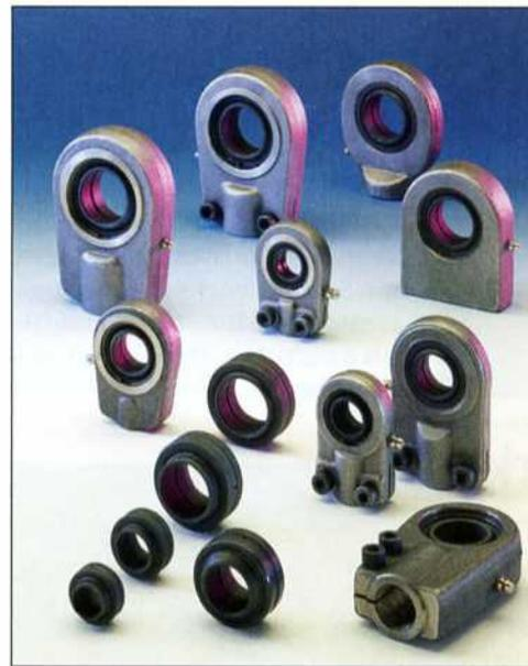
übertragung durch Hydraulikzylinder bietet der Gelenklagerspezialist Fluro aus Rosenfeld in Baden-Württemberg. Die Gelenkköpfe dienen als Befestigungsteile für die Kolbenstange und sind entsprechend den genormten Zylinderinnendurchmessern und Druckstufen ausgelegt. Für die Verbindung zur Kolbenstange lassen sich die Hydraulikgelenkköpfe wahlweise aufschrauben oder anschweißen. Die Befestigungsge-
