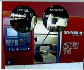
Mit der Hochpräzisions- und Produktionsmaschine 202TG kann der Anwender in einer Aufspannung beispielsweise drehen und schleifen.
