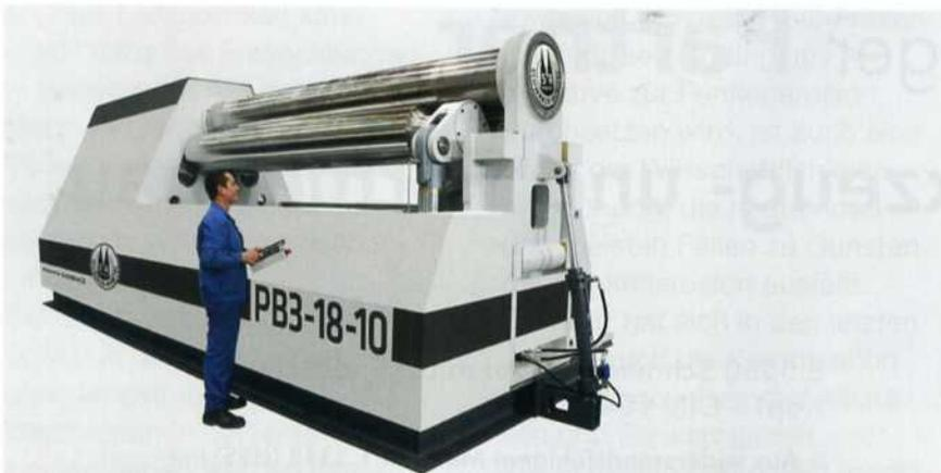
**16** Konusse und Zylindern für Offshore-Projekte, architektonische Strukturen, Maschinenkonstruktionen, Tanklager etc.: Aufträge dieser Art realisiert Kersten Europe nun auch mit der Blechrundbiegemaschine PB3-18-10 von Schwarze-Robitec. Mit der PB3-18-10 verfügt der auf Blech- und Profildiegen spezialisierte Lohnfertiger über eine leistungsstarke Maschine mit großem Drehmoment, einer Konusbiegevorrichtung und gehärteten Walzen für die Umformung von Edelstahlblechen
