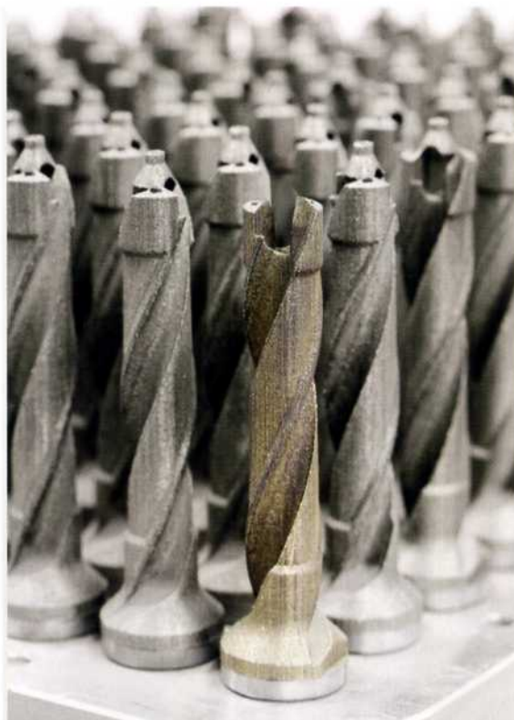
Seit 2013 wird bei Präzisionswerkzeughersteller Mapal an der Werkzeugproduktion mit Hilfe der additiven Fertigung geforscht. Das erste Serienprodukt ist der innengekühlte Schneidplattenbohrer QTD für Durchmesser von acht bis 13 Millimeter, der mittels Lasersintern hergestellt wird. Bild: Mapal
