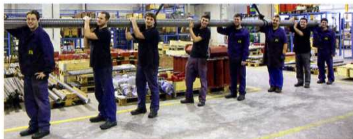
Die mit knapp 12 m Länge und 160 mm Durchmesser größte von der Maschinenfabrik Albert hergestellte Spindel.
