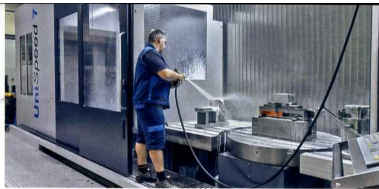
Die neue UniSpeed 7 von SHW Werkzeugmaschinen erleichtert dem Bediener mit nur einer Stufe bis zur Aufspannfläche die Zugänglichkeit und ist Teil des verbesserten Ergonomiekonzepts.
