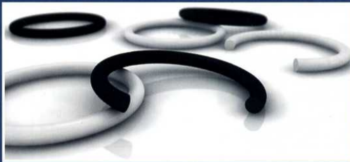
1: Flachdichtungen und O-Ringe für die gebräuchlichsten Normen für hygienege-rechte Kupplungen, wie zum Beispiel ISO 2852, DIN 11864 und DIN 32676. Sie sind in EPDM- und FKM-Werkstoffen erhältlich, die speziell für diese Anwendungen entwickelt wurden und zahlreichen Branchennormen genügen sowie anhand dieser getestet wurden
