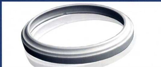
3: Der aus weißem WUAW5-Polyurethan bestehende Zurcon-Abstreifer ASW ist ein einfachwirkender Abstreifer mit zusätzlichem Stützwulst an der Innenfläche, der ein Kippen und Drehen in der Nut verhindert. Gleichzeitig sorgt dies für einen festen Sitz in der Nut, sodass ein Eindringen von Schmutz über die Rückseite des Abstreifers verhindert wird
