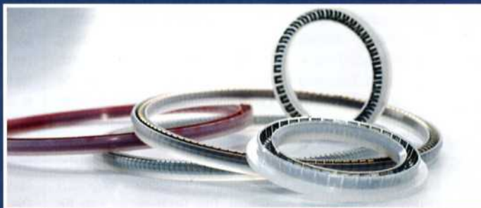
2: Komplett sterilisierbare, einfachwirkende Dichtung mit einem U-förmigen Dichtungskörper und einer V-förmigen, korrosionsbeständigen Feder. Die Dichtung sorgt für eine geringe Reibung, eine lange Standzeit und verfügt selbst in hochviskosen Medien über einen ausgezeichneten Abstreifeffekt
