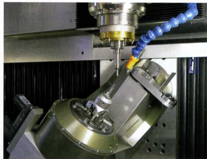
Bei der „E-Jet 400 5D“ wurde die Präzision, die in der Uhren- und Feinwerktechnik Standard ist, auf den Bedarf des Formenbaus (speziell der Elektrodenfertigung) adaptiert.
