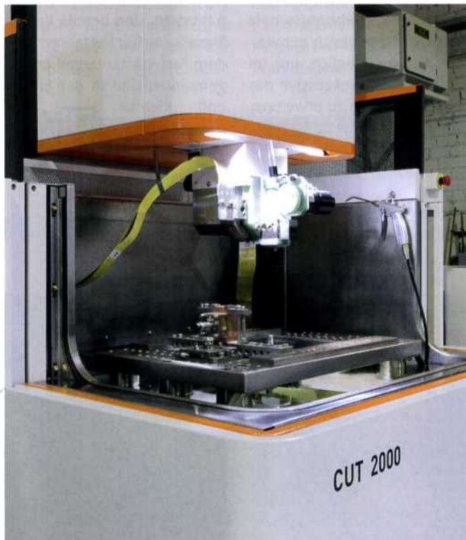
Der absenkbare Arbeitsbehälter der »CUT 2000« von GF Machining Solutions gestattet einen hervorragenden Zugang und ausgezeichnete Sicht auf die gesamte Arbeitszone.
