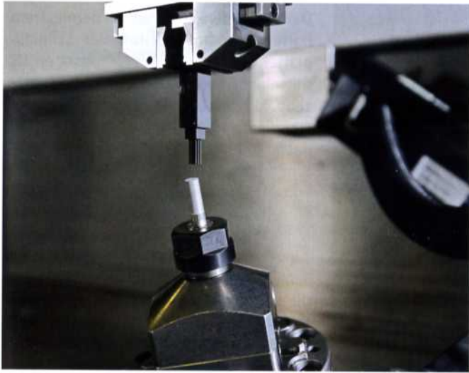
In ein Probewerkstück aus Magnesium werden zur Erforschung mittels einer Senkelektrode 0,4 bis 0,8 mm große Kanäle eingebracht.
