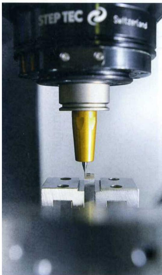
▲ Mit Fräswerkzeugen nur 0,1 mm Durchmesser werden mit bis zu 42000 U/min Konturen in Stempel und Matrizen für die Hochleistungswerkzeuge gefügt
