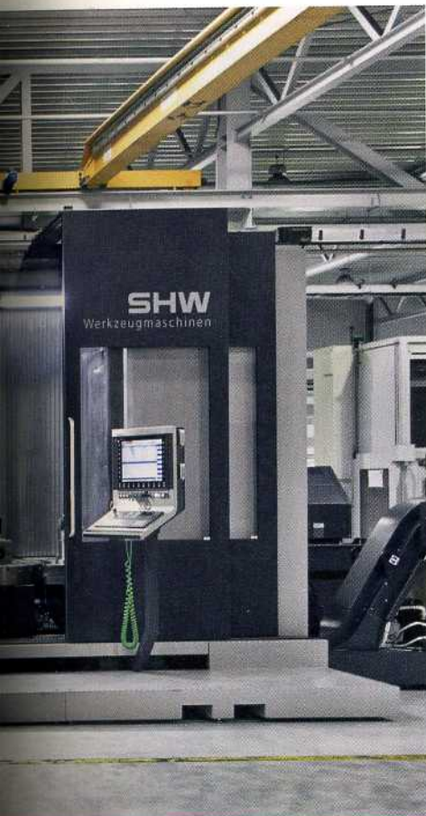
3 Mit nur einer Stufe bis zur Aufspannfläche ist eine leichte Zugänglichkeit zum Maschinenraum garantiert. Das ist Teil des verbesserten Ergonomiekonzepts der Unispeed.
