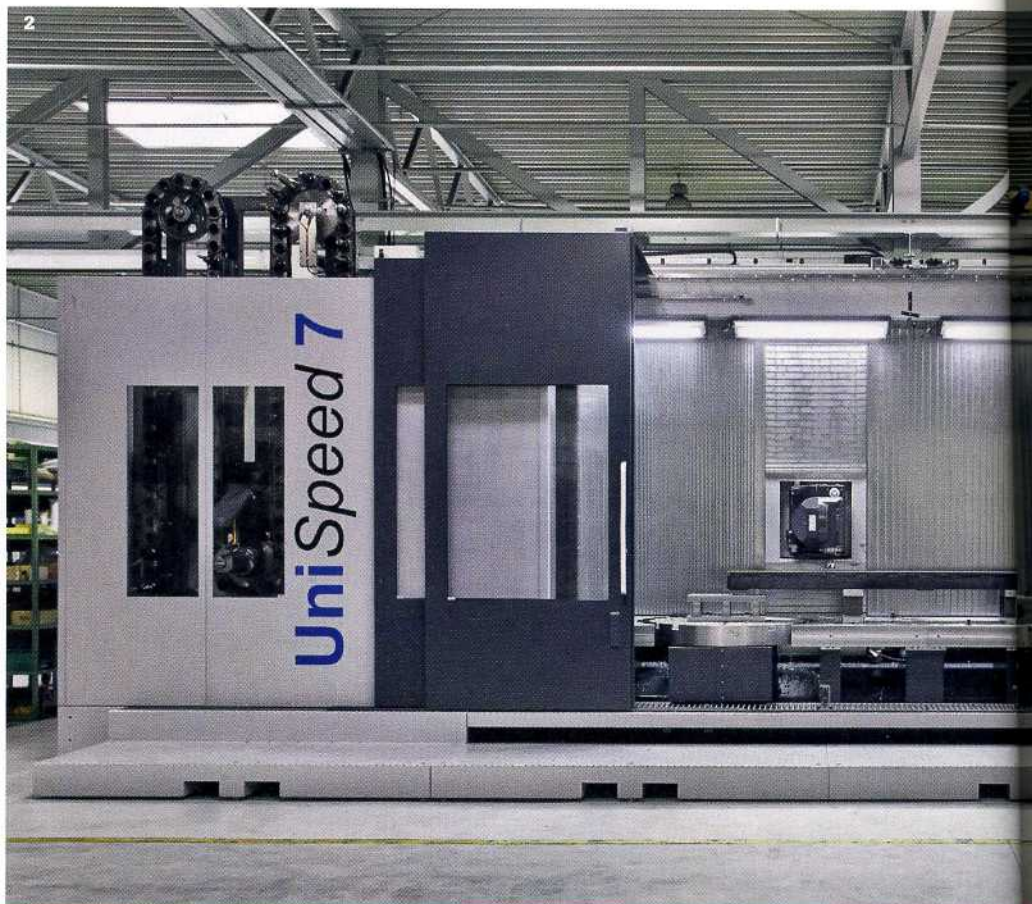
1 Die UniSpeed 7 hat einen automatischen Werkzeugwechsler sowie Pick-up-Station für Werkzeuge. 2 Die UniSpeed 7 kann Werkstücke bis sechs Meter Länge bearbeiten.
