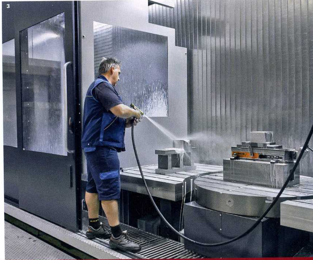
3 Mit nur einer Stufe bis zur Aufspannfläche ist eine leichte Zugänglichkeit zum Maschinenraum garantiert. Das ist Teil des verbesserten Ergonomiekonzepts der Unispeed.
