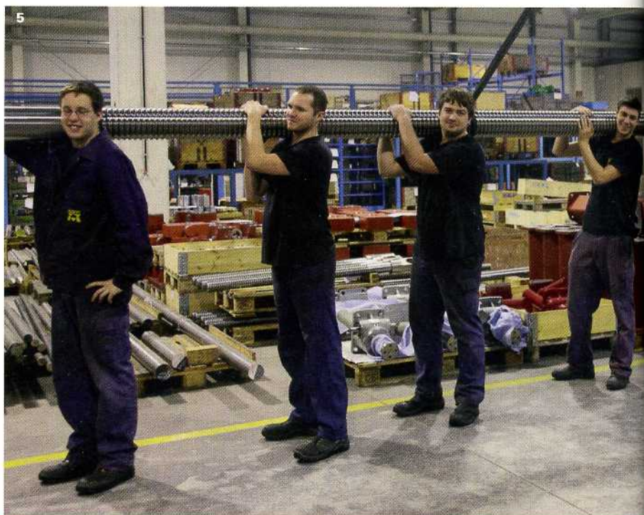
5 Die größte Spindel hat eine Länge von 12 Meter und einen Durchmesser von 160 Millimeter.
