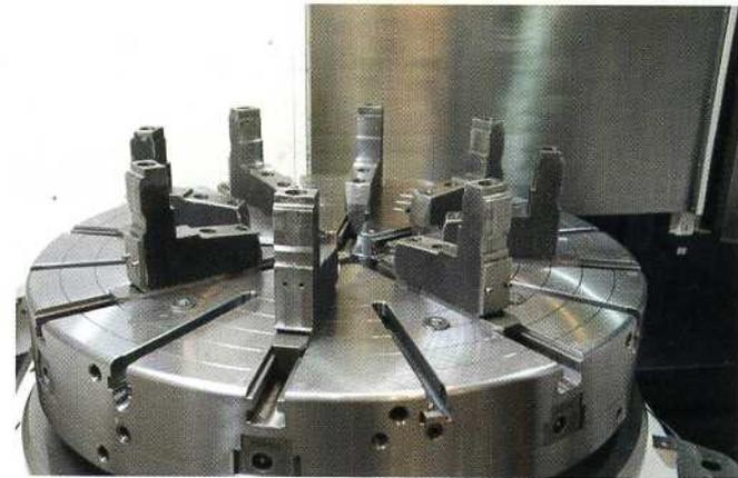
einsetzen und mehrmals umzuspannen«, erinnert sich Helde. Für die schnelle und effiziente Fertigung von Domdeckeln und anderen Verschlüssen aus Edelstahl für Behälter – die Domäne, auf die sich Zimmerlin spezialisiert hat – bringt das seit Anfang 2014 eingesetzte Futter deutliche Verbesserungen.
