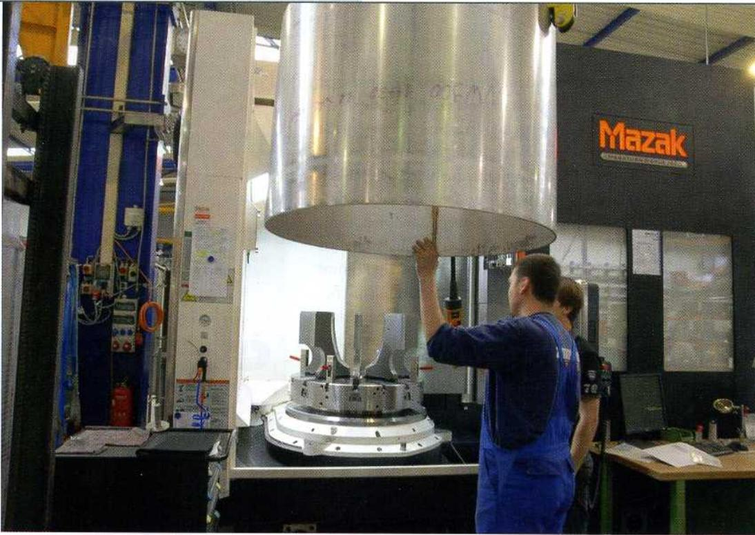
1 Mit dem seit Anfang 2014 eingesetzten 8-Backenfutter von Röhm mit Backen-Schnellwechselsystem reduziert Zimmerlin die Rüstzeiten deutlich
