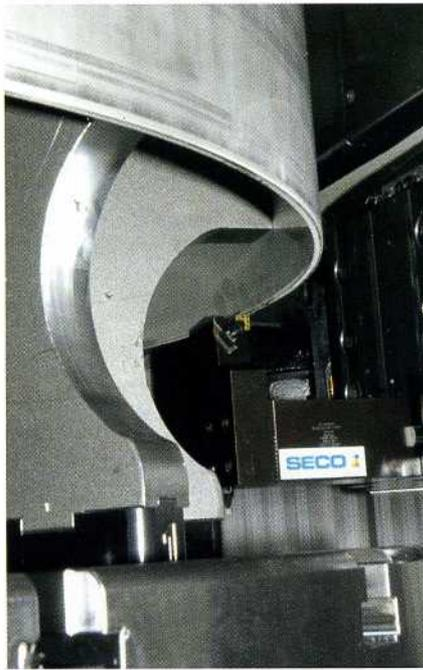
4 Durch spezielle Spannbacken ist die 3-Seiten-Bearbeitung möglich
