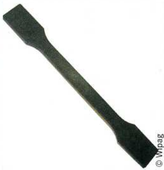
Bild 7: CFK ist jetzt auch als Granulat verfügbar, aus dem sich z.B. Prüfkörper für die Klebstoffindustrie im Spritzgussverfahren herstellen lassen.
