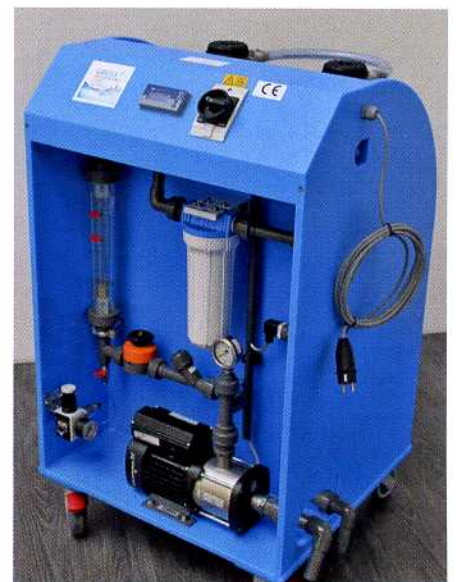
Kompakte Anlagen zum Deionisieren von Wasser für die Funkenerosion; rechts die neuere Ausführung GW1800MB für das Schneiden von Hartmetall und Polykristallinem Diamant
