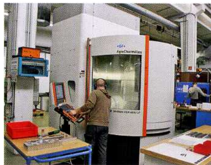
Mikron HSM 600 ULP bei Rejlek für die 5-Achs-Bearbeitung mit kurzen Werkzeugwechselzeiten
