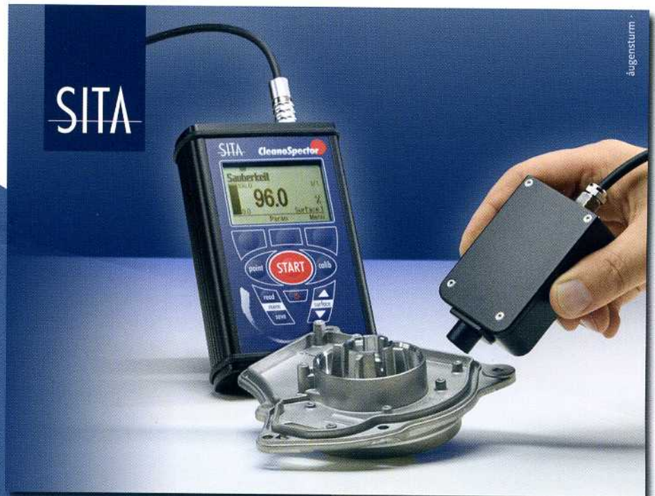
Sauberkeitskontrolle durch Fluoreszenzmessung
