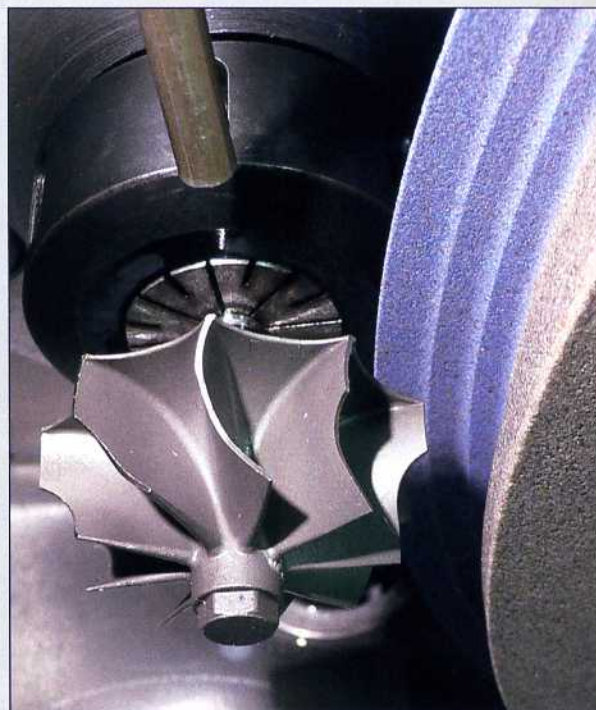
Mit der Doppelspindel-Rundschleifmaschine Vector Twin Mark III lassen sich zum Beispiel Impeller reinstbearbeiten.
