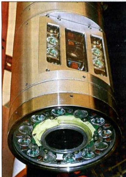
Eine Schachtkamera, basierend auf Sperix-Technologie, liefert hochauflösende Digitalbilder von Revisionsschächten. Bild: JT-elektronik
