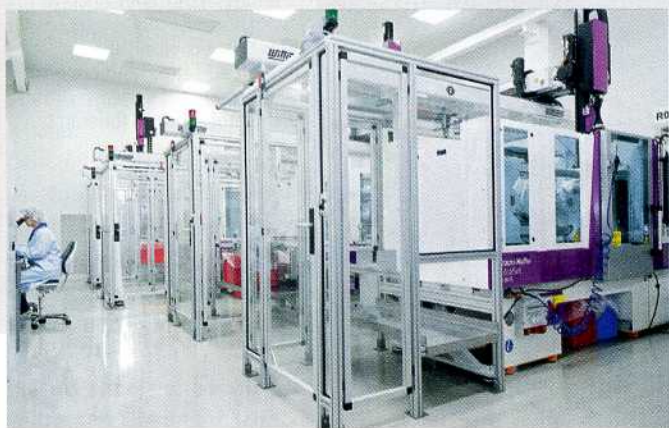
Die Fertigung erfolgt automatisiert unter Reinraumbedingungen
