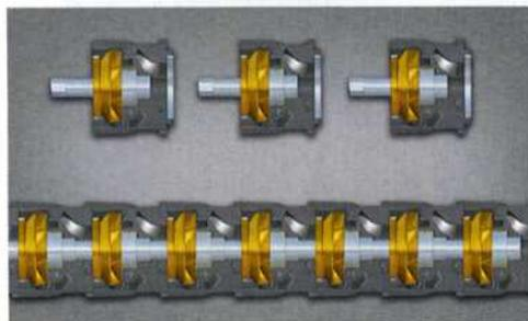
Die Pumpengeneration in MS-T-Bauweise von Ritz hat keine durchgehende Welle. Stattdessen werden einzelne Pumpenmodule mit einem Gehäuse und einer laufradintegrierten Antriebswelle einfach nach Bedarf ineinander gesteckt, bis die Pumpleistung den Förderbedingungen entspricht. Jedes Laufrad ist somit einzeln gelagert. Zu zehn, zwölf oder auch zwanzig
