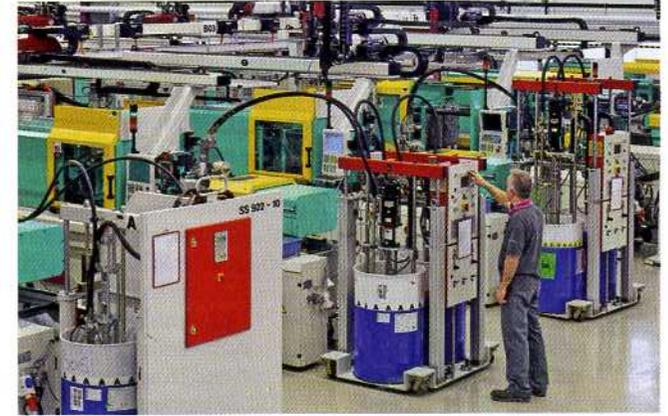
Im Produktionswerk Trelleborg Sealing Solutions entstehen hochpräzise und komplexe LSR-Formteile Foto: Trelleborg
