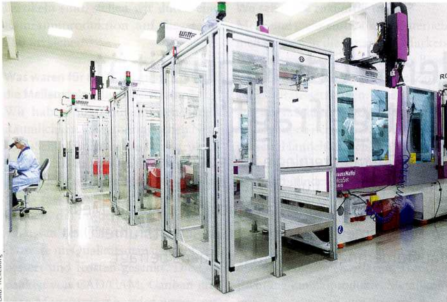
Bild 2 | Produktion im Reinraum: In Stein am Rhein verfügt Trelleborg über Reinräume der Klasse 8 und Klasse 7. Eine vollautomatisierte Produktion erhöht zusätzlich die Sauberkeit.
