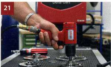
21 Mit einer Messbank Schraubwerkzeuge intern warten und kalibrieren.
