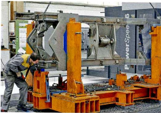
**Bild 3:** Von Liebherr eigens gefertigte Vorrichtungen bringen die Werkstücke in Position.
