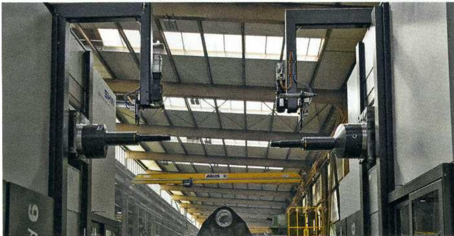
Bild 6: Beide Maschinenstände der Powerspeed 6 wechseln die Werkzeuge vollautomatisch und unabhängig voneinander.
