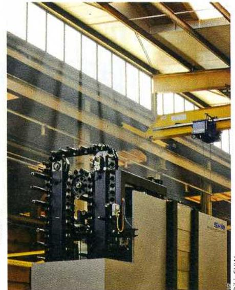
Bild 7: Jeder Maschinenstand der Powerspeed 6 greift auf einen Werkzeugwechsler mit bis zu 150 Werkzeugen zu.
