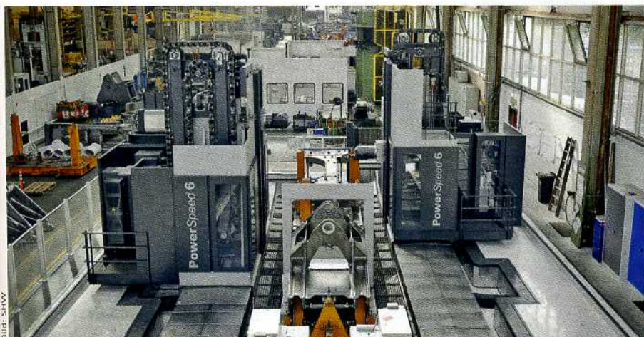
Bild 2: Für die Fertigung setzt Liebherr auf eine Fahrständermaschine SHW Powerspeed 6 mit Doppelständer für die Parallelbearbeitung.
