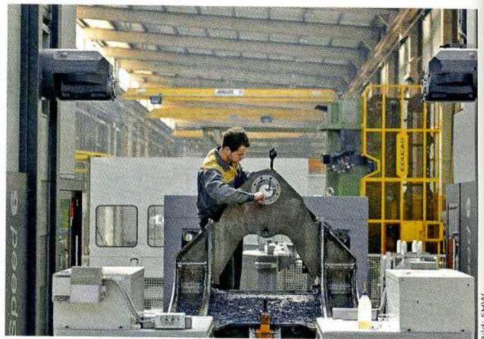
**Bild 4:** Auf der Powerspeed 6 von SHW Werkzeugmaschinen werden bei Liebherr Vorder- und Hinterwagen der Radlader bearbeitet.
