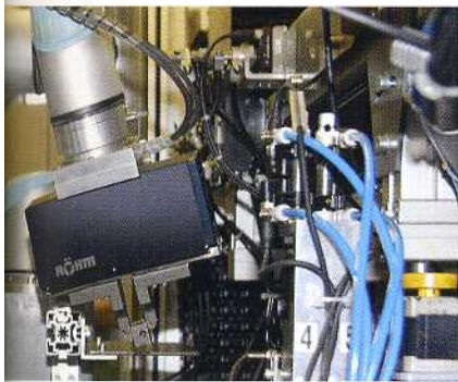
Oben: Quergelegt übergibt der Röhmm-Greifer bis zu 4000 Teile täglich zur Prüfeinheit.
