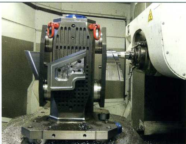
3 GF Machining Solutions hat die beiden Mikron HPM 1350U auf die bei BMW übliche Trockenfräsbearbeitung angepasst
