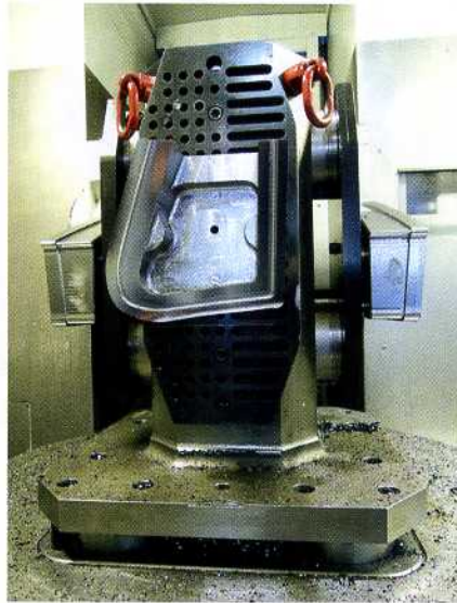
4 Aufspanntürme in den Mikron-Maschinen gehören zum Optimierungsspektrum für den Werkzeugbau von BMW München
