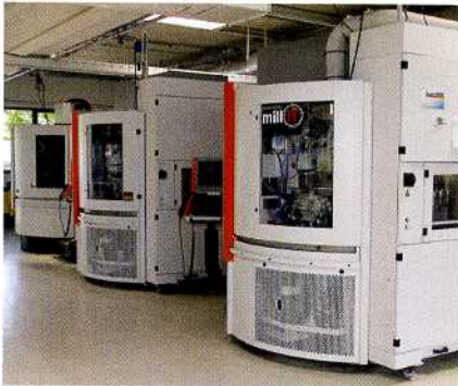
Inzwischen stehen bei millhouse drei Fräsmaschinen Mikron HSM 400 U von GF Machining Solutions samt Linearautomatisierung.
