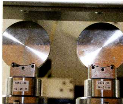
Die Rohlinge gibt es als Ronden in unterschiedlichen Materialien und Stärken. Sie werden über verschiedene Bearbeitungen optimal ausgenutzt.
