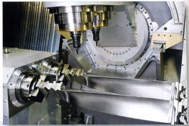
Bild 2: Maschine bei der Herstellung von Schaufeln für Flugzeugtriebwerke und Turbinen (Werkbilder: Georg Fischer AG, CH-Schaffhausen)
