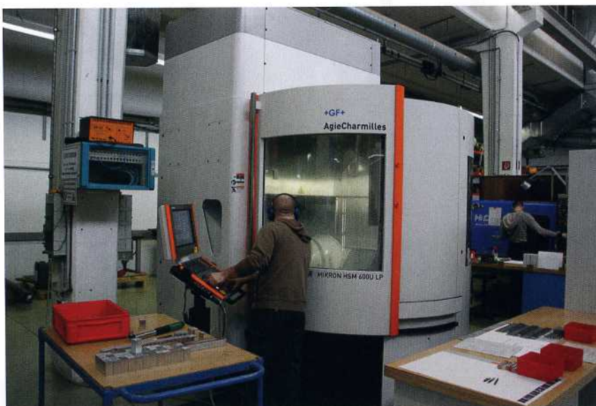
Bild 4: Mit der Mikron HSM 600U LP investierte Rejlek vor allem in 5-Achs-Bearbeitung mit schnellen Werkzeugwechselzeiten
