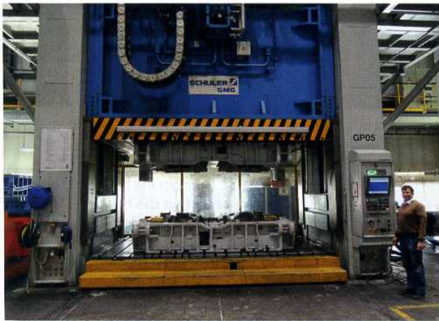
Bild 6: Der BMW Werkzeug- und Anlagenbau in München fertigt Werkzeuge für die Presswerke in aller Welt. Jürgen Heinzer neben einer der sechs Erprobungspresen in München
