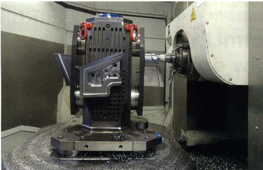
Bild 4: GF Machining Solutions hat die beiden Mikron HPM 1350U angepasst auf die bei BMW übliche Trockenfräsbearbeitung
