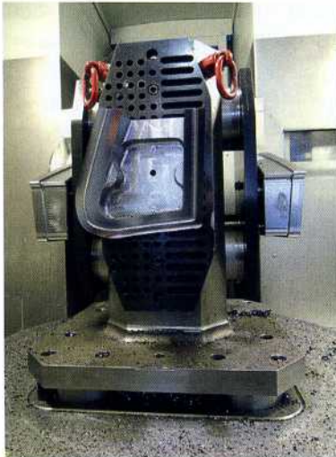
Bild 3: Aufspanntürme in den Mikron Maschinen gehören mit zum Opti- mierungsspektrum
