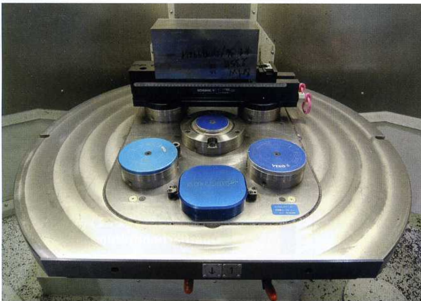
Bild 7: Nullpunktspannsysteme ziehen sich durch alle Fertigungsstationen bei BMW Werkzeug- und Anlagenbau (Werkbilder 1-7: GF Machining Solutions Agie Charmilles GmbH, Schorndorf)
