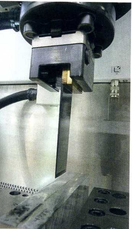
Die Form 2000VHP ist die erste Senkerodiermaschine von GFMS mit der iGap-Technologie, die zwischen lateralen und frontalen Funken unterscheidet. Die unerwünschten seitlichen Funken können so abgeschaltet werden.
