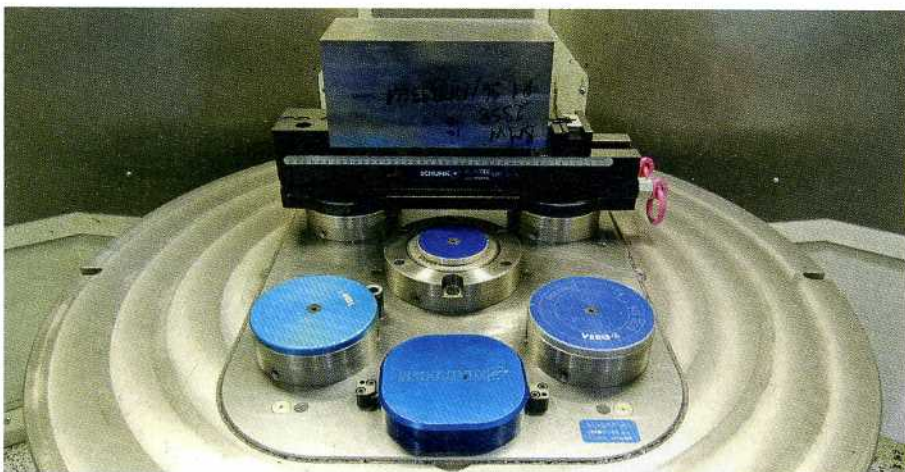
Bild 5: Nullpunktspannsysteme ziehen sich durch alle Fertigungsstationen im BMW-Werkzeugbau.
