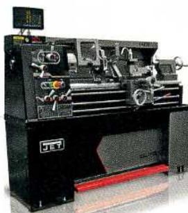
Digitalanzeige erlaubt präzise Drehgeschwindigkeiten. Zwei Getriebe ermöglichen niedrige Geschwindigkeiten von 40-365 bis 165-2500 min<sup>-1</sup>. Die Präzisionskugellager der Güteklasse 7 halten die Spindel auf maximal 0,0004“.
