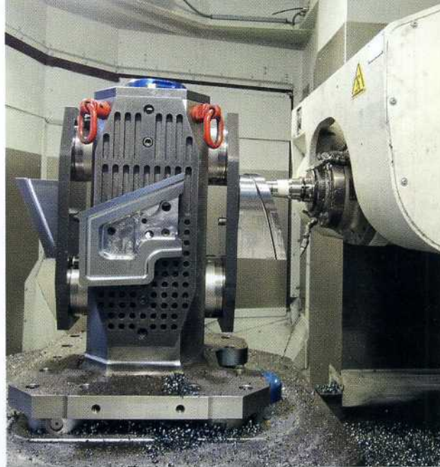
GF Machining Solutions hat die beiden Mikron HPM 1350U angepasst auf die bei BMW übliche Trockenfräsbearbeitung Bild: GF
