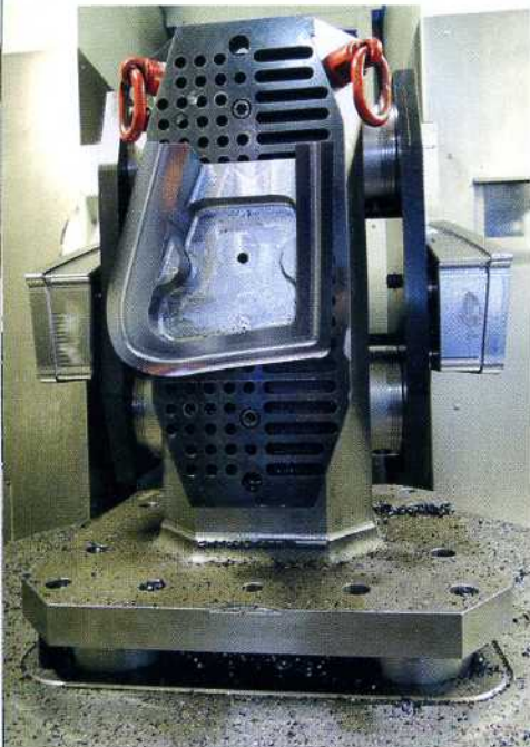
Aufspanntürme in den Mikron Maschinen gehören mit zum Optimierungsspektrum Bild: GF
