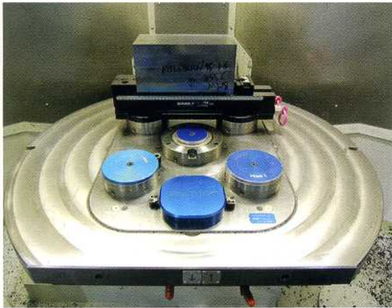
Nullpunktspannsysteme ziehen sich durch alle Fertigungsstationen bei BMW Werkzeug- und Anlagenbau Bild: GF
