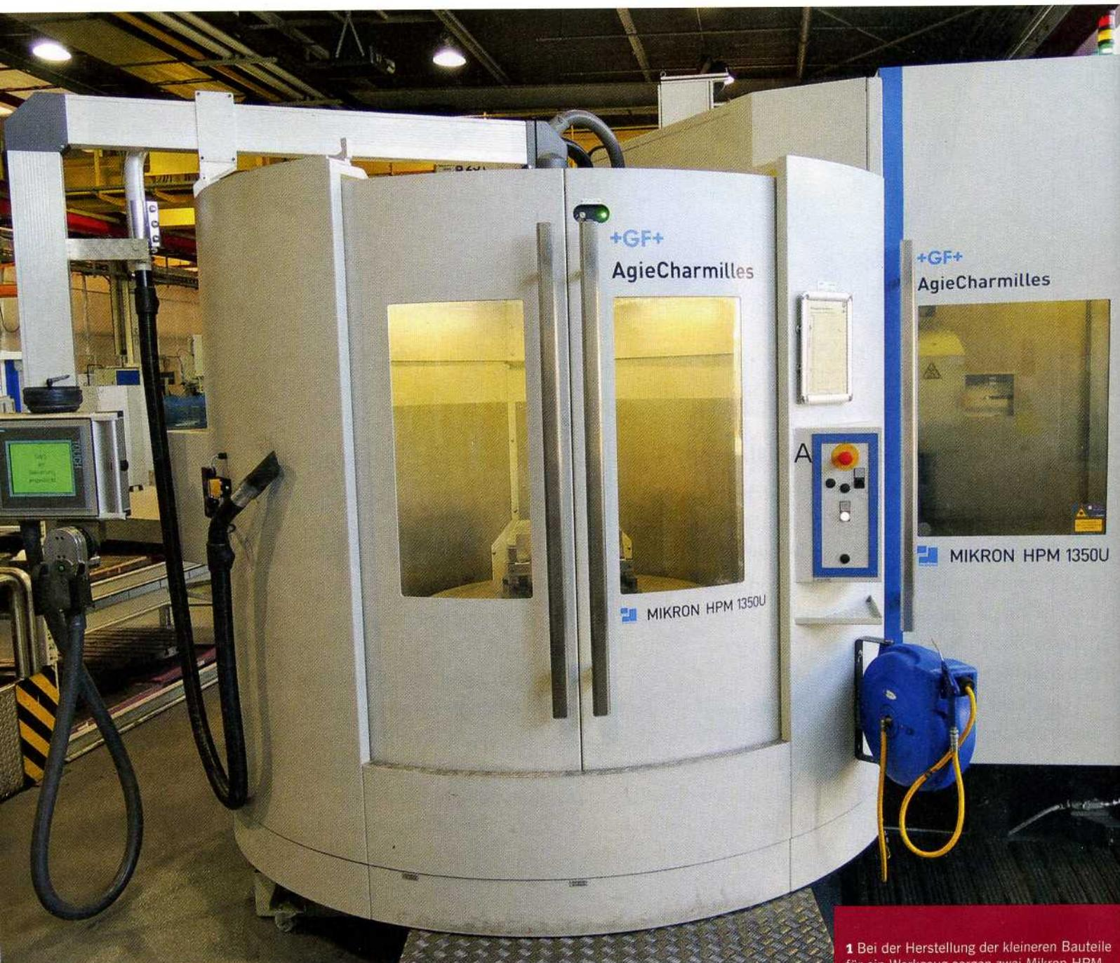
1 Bei der Herstellung der kleineren Bauteile für ein Werkzeug sorgen zwei Mikron HPM 1350U von GF Machining Solutions mit Werkzeug- und Palettenwechsler für eine deutlich höhere Produktivität.
