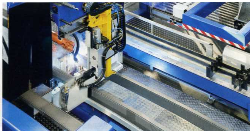
In die Roboterschweißzelle werden die profilierten Traversen und die entsprechenden Laschen automatisch zugeführt und verschweißt
