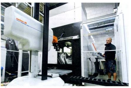
Läuft rund um die Uhr: Die automatisierte Zelle fräst und erodiert im Dauerbetrieb und sorgt damit für Durchlaufzeitverkürzung im Spritzgussformenbau Bild: Messe Stuttgart
