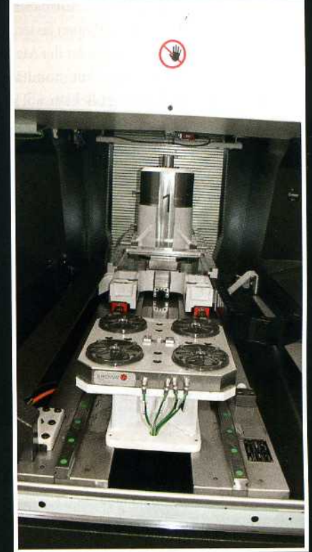
▲ Erowa-Palette in der Transferstation der Mikron-Maschine
