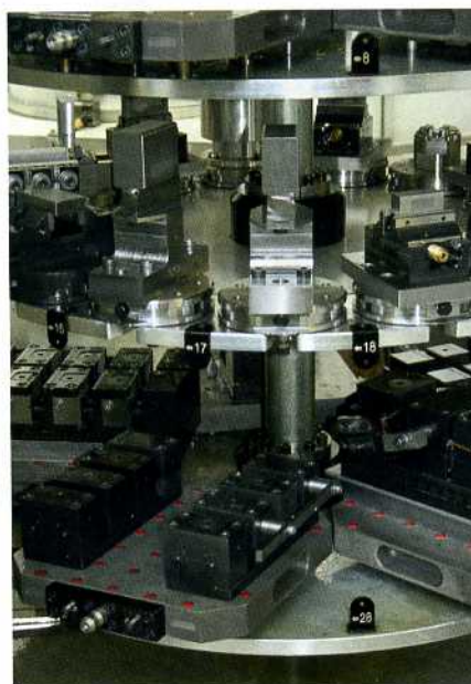
▲ In einem Rotary-Magazin werden die unterschiedlichsten Werkstücke auf Erowa-Paletten platziert
