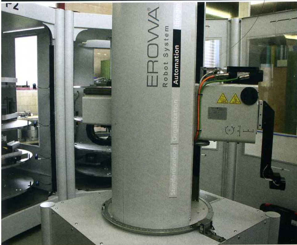
▲ Ein Erowa Robot System versorgt die Mikron HPM 600U aus drei Drehmagazinen heraus
