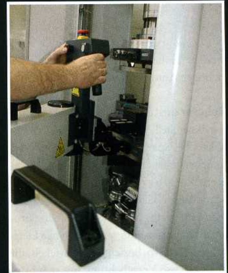
▼ Zum Bestücken der Rotary-Magazine mit Paletten kann der Bediener auf die Handhabungshilfe Erowa-Lift zugreifen
