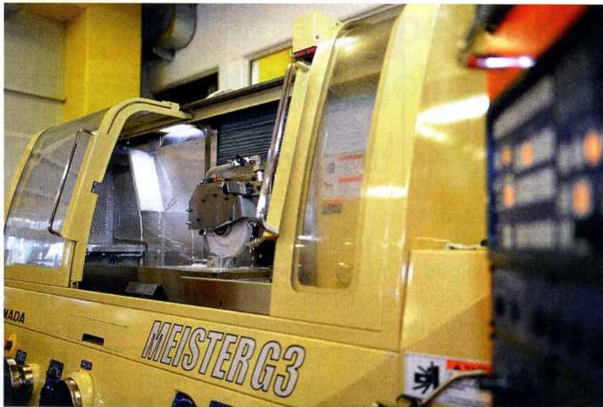
Bild 2: Die Amada Meister G3 ermöglicht die Komplettbearbeitung auf einer Maschine und ersetzt mit ihrer Universalität zwei herkömmliche Schleifmaschinen
