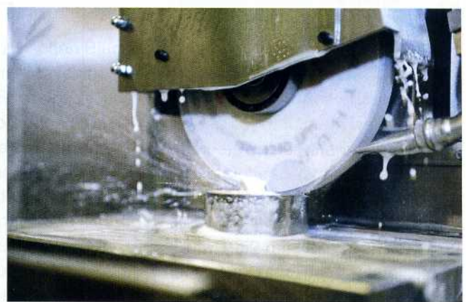
Bild 4: Bei Blum ist man beeindruckt von der sehr hohen Genauigkeit der Amada Flach- und Profilschleifmaschinen. Die geforderte Präzision mit +/- 2,5 µm Toleranz ist machbar
