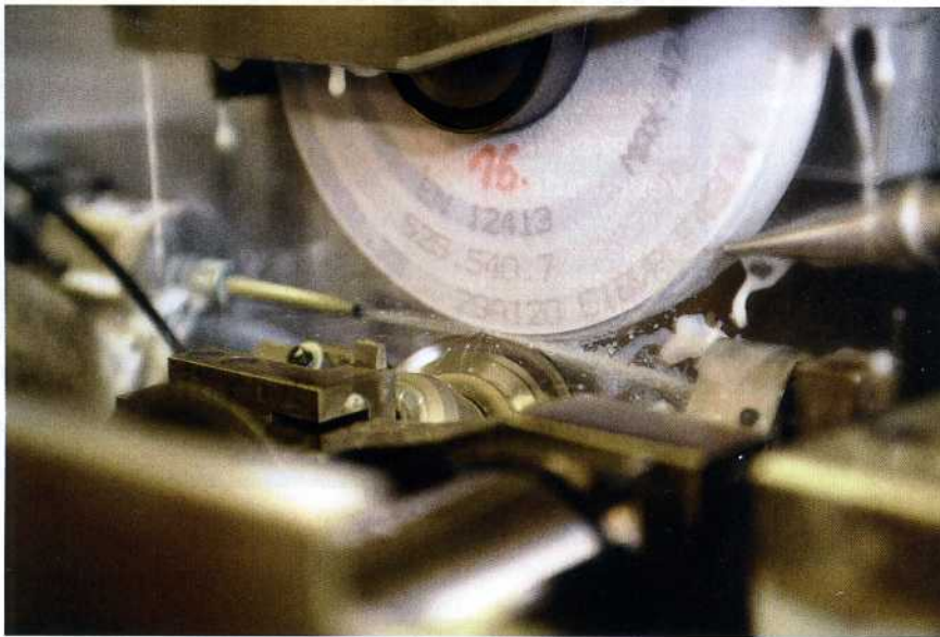
Bild 5: Zur hohen Genauigkeit kommt die durchdachte Abrichtfunktion der Amada Schleifmaschinen. Dafür sorgt die funktionelle CNC-Schleif- und Abrichttechnologie TPA/VPA zum Profilieren der Schleifscheibe
