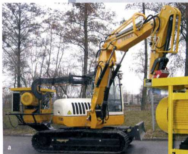
Bild 1: Raupenbagger (a), der mit einem zusätzlichen Elektromotor-Pumpen-Aggregat (b) für das Arbeiten in Tunneln aufgerüstet wurde.
