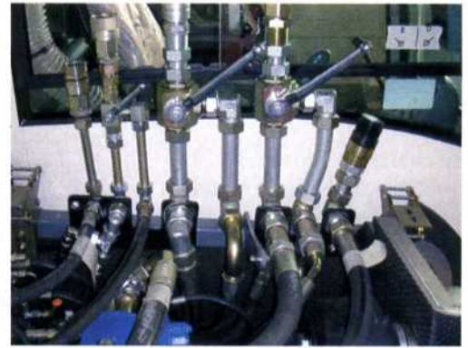
Bild 3: Kugelabsperrröhre trennen die beiden autonomen Hydraulikkreisläufe voneinander.
