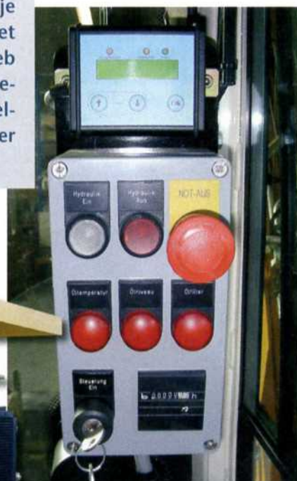
Bild 2: Das zusätzliche Hydraulikaggregat wird aus der Führerkabine heraus zu- oder abgeschaltet.
