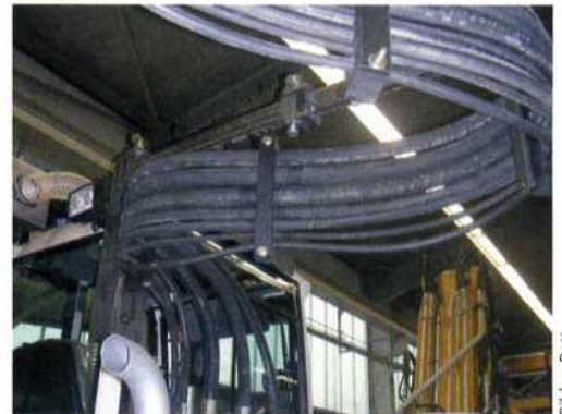
Bild 4: Eine s-förmige Schlauchführung erlaubt ein Drehen des Baggeroberwagens um bis zu 120° in beide Richtungen.
