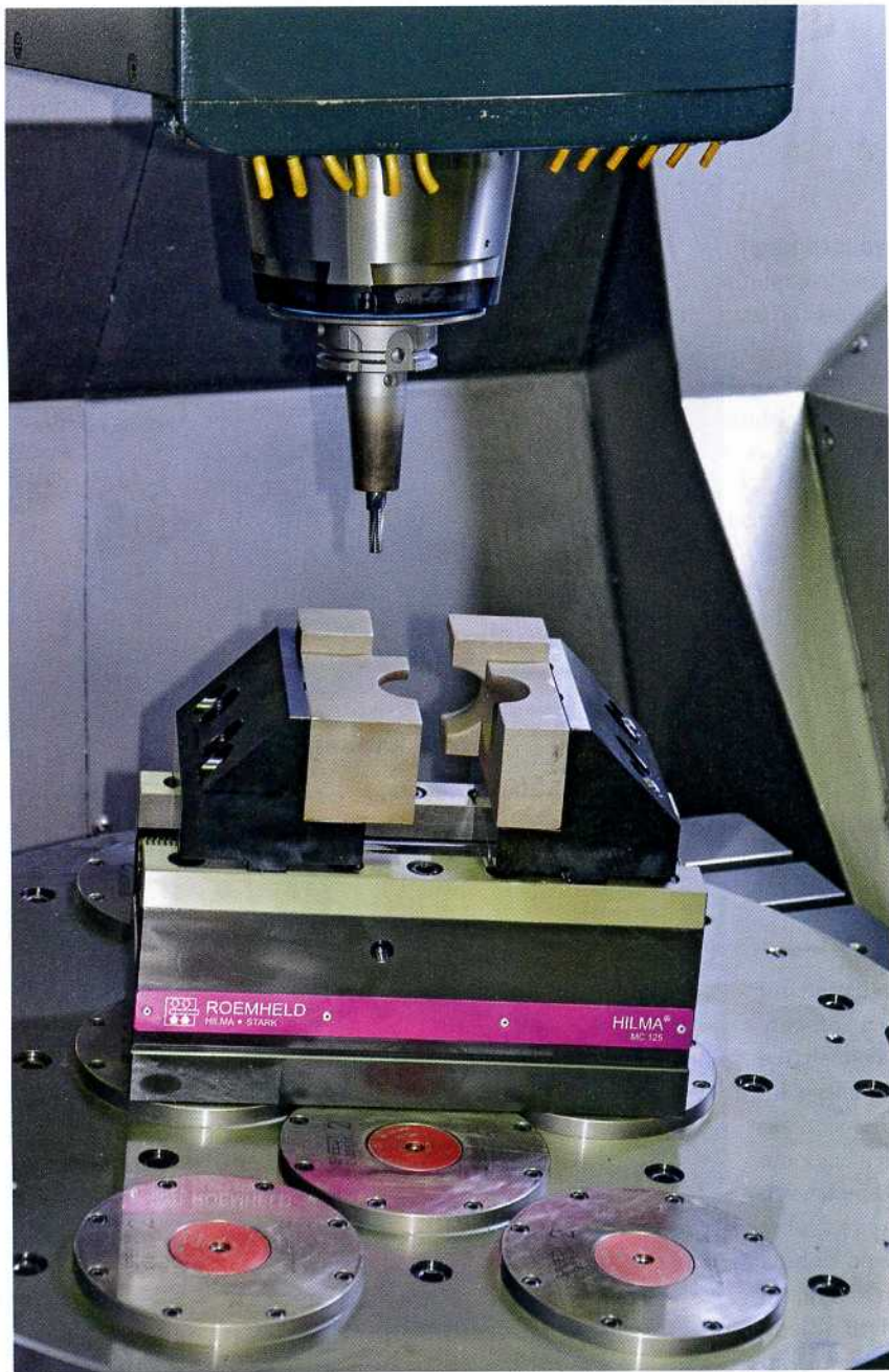
Gute Zugänglichkeit von allen Seiten und kollisionsfreie Werkzeugwege bei der 5-Achs-Bearbeitung garantieren Spannmittel mit kompakten Bauformen Bild: Römheld
