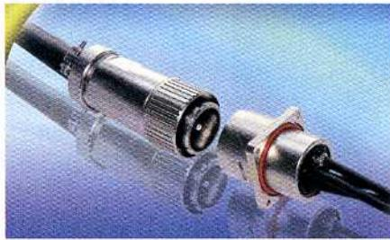
Stecker sind für den Anschluss von Litzen bis 8 mm<sup>2</sup> (Derating beachten) ausgelegt und mit Standardwerkzeugen verarbeitbar. Der Ground-Kontakt ist voreilend, so dass die Stecker auch für Anwendungen geeignet sind, bei denen der Ground-Kontakt vor den drei Power-Kontakten hergestellt sein muss.
