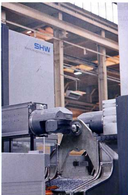
Bild 3: Tête à tête: Die beiden Orthogonal-köpfe arbeiten parallel
