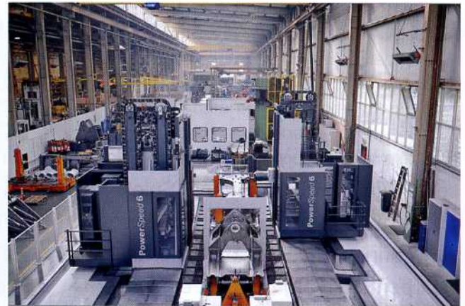
Bild 2: Für die Fertigung setzt Liebherr auf eine Fahrständermaschine SHW PowerSpeed 6 mit Doppelständer für die Parallelbearbeitung
