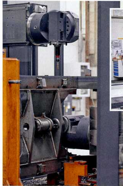
Bild 5: Doppelarbeit: Während ein Kopf Gewinde schneidet (o.), ist der andere noch beim Fräsen (u.)
