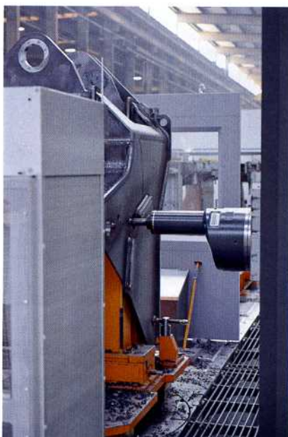
Bild 9: Das Kopfwechselsystem der PowerSpeed 6 wechselt vollautomatisch den benötigten Bearbeitungskopf ein
