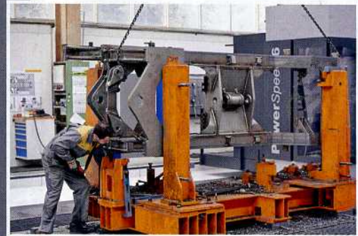
Bild 6: Von Liebherr eigens gefertigte Vorrichtungen bringen die Werkstücke in Position
