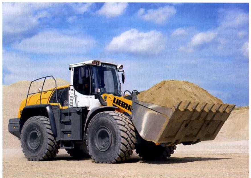
Bild 4: Radlader in allen Größen, von fünf bis rund 34 Tonnen, mit Schaufeln, die mit einem Mal bis zu 14 m 3 aufladen können, werden bei Liebherr in Bischofshofen hergestellt
