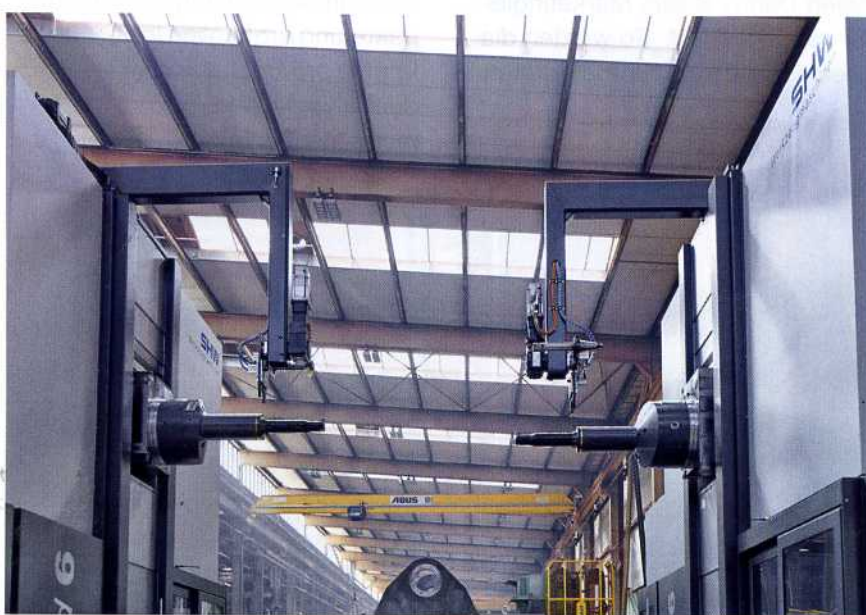
Bild 12: Beide Maschinenständer der PowerSpeed 6 wechseln die Werkzeuge vollautomatisch und unabhängig voneinander (Werkbilder: SHW Werkzeugmaschinen GmbH, Aalen-Wasserralfingen; Applikation Liebherr Radlader)
