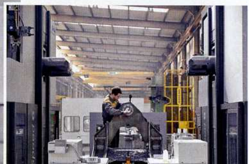
Bild 7: Auf der PowerSpeed 6 von SHW Werkzeugmaschinen werden bei Liebherr Vorder- und Hinterwagen der Radlader bearbeitet
