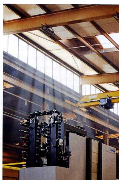
Bild 11: Jeder Maschinenständer der PowerSpeed 6 greift auf einen Werkzeugwechsler mit bis zu 150 Werkzeugen zu
