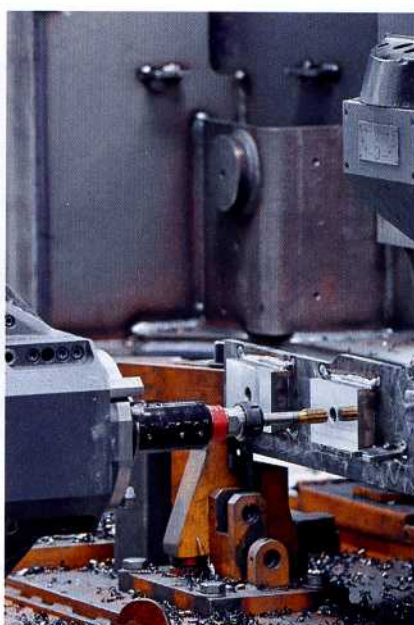
Bild 10: Neben Fräsen, Bohren und Reiben gehört auch Gewindeschneiden zu den Bearbeitungsschritten
