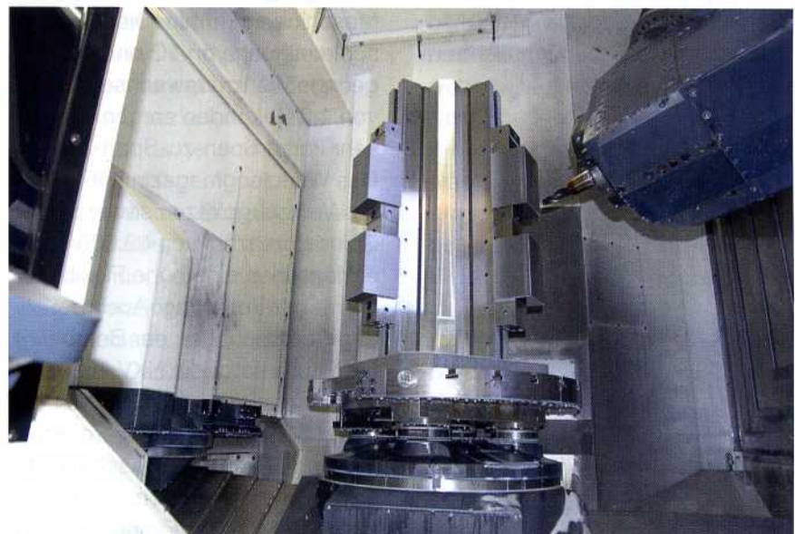
Bild 6: Kollisionsgefahr gebannt: Der Aufspannturm bietet genügend Freiraum für den Bearbeitungskopf (Werkbilder: Röhm GmbH, Sontheim a.d. Brenz)
