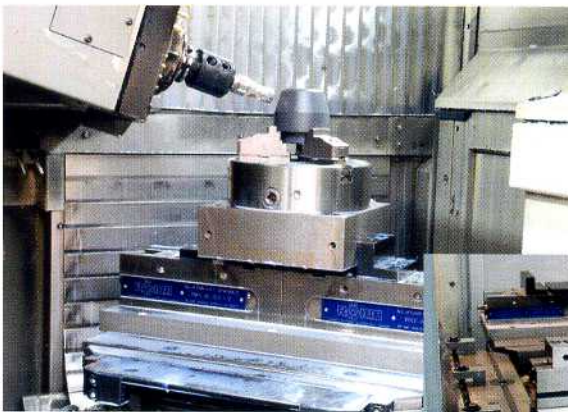
Großer Kopf bearbeitet kleines Teil. Fleischer schafft durch Eigenlösungen mithilfe von Röhm-Schraubstöcken größtmögliche Freiheit.
