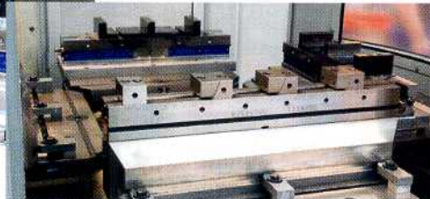
FL-Spannleiste: Wechselplatte und Röhm-Spannleisten erhöhen die Produktivität und Flexibilität beim Lohnfertiger Roland Fleischer.
